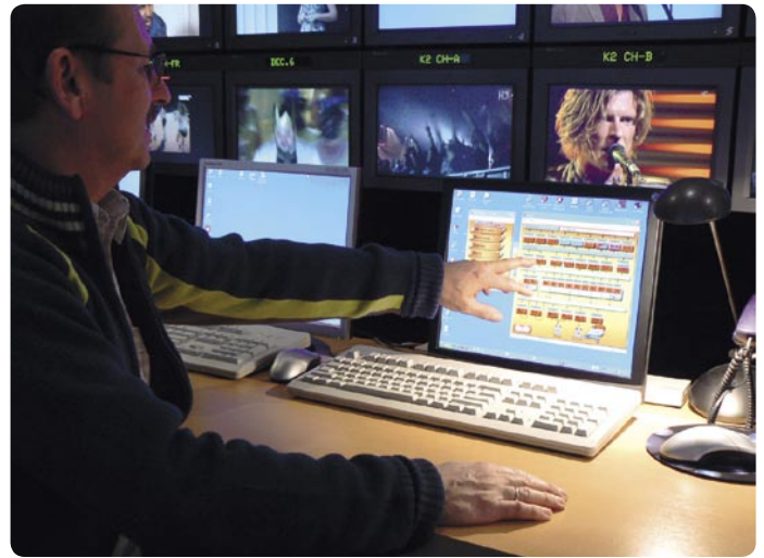
▲ Le directeur technique M. Jacques Schepers explique la pièce principale de la console de gestion : Les signaux peuvent être transmis aux deux transpondeurs Astra, au transpondeur Eutelsat ou au réseau câblé par un simple clic de souris.
