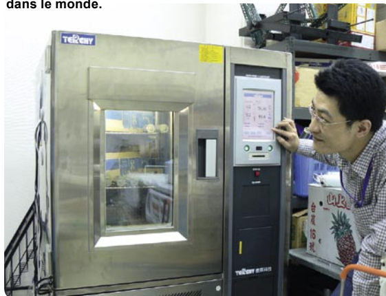
Des échantillons sont prélevés de la ligne de production et sont testés dans des chambres simulant des conditions climatiques extrêmes. Ici, ce four chauffe à 70 °C. Les tests vont de -40° à +90 °C.
