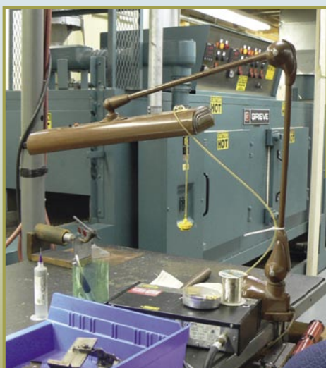
■ ... le procédé de soudure réel a lieu en ce four de soudure dans lequel les filtres passent.
