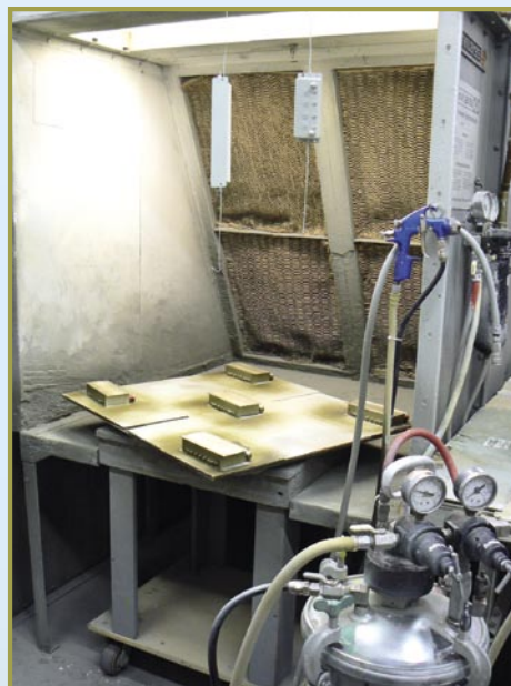
■ MFC font pratiquement tout eux-mêmes : les filtres finis sont pulvérisés ici avec un enduit protecteur coloré.
