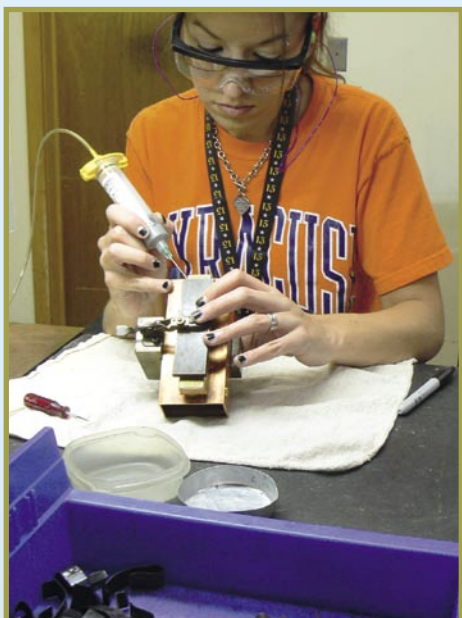
■ Ici un filtre est assemblé mécaniquement. L'employée de MFC Melissa Bench prépare un filtre pour le four de soudure...
