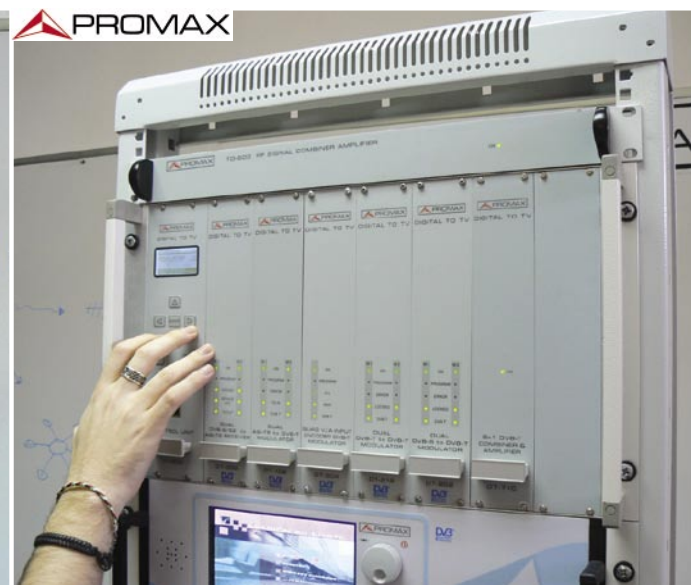
■ La théorie est démontrée par l'intermédiaire d'un raccordement réel : chaque logement représente une source possible de signal. À l'autre extrémité vous obtenez un signal combiné en DVB-T.
