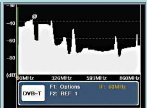
Les fréquences actives peuvent être facilement identifiées à l'écran de l'analyseur de spectre |
