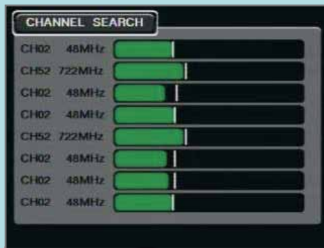
La recherche multi-chaîne du DVB-T permet d'afficher simultanément 8 signaux de la qualité des chaînes |
