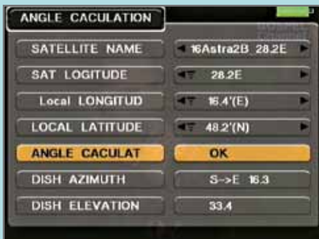
Le calcul de l'angle simplifie l'installation d'une antenne |
