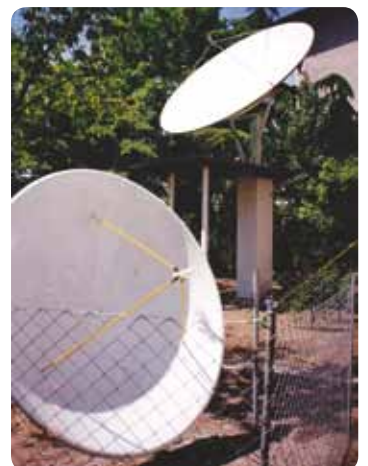
■ La petite antenne de 1,5 mètre en premier plan, est utilisée par Cahit pour capter ASTRA2 à 28°2
