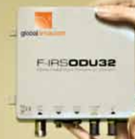
■ Samantha Bransgrove, en charge du Marketing et Communication chez Global Invacom, nous montre ici, l'un des premiers prototypes F-IRS ODU32. Le câble coaxial issu de la tête (LNB) F-IRS est branché ici, avec le câble provenant de l'antenne terrestre; Les deux sorties optiques délivrent les signaux combinés de TV par satellite et de TNT.
