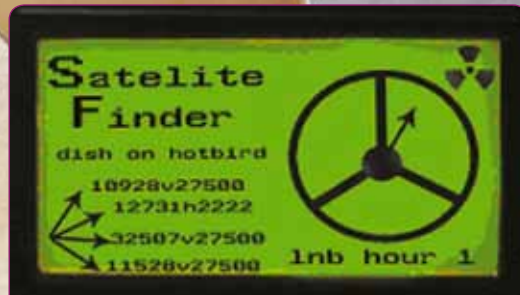
■ L'affichage du viseur intelligent de satellite indiquant les transpondeurs les plus puissants avec le skew de la tête ( LNB)
