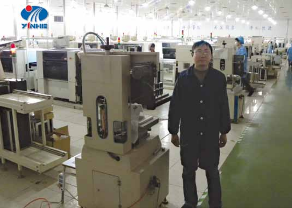
■ 11 chaînes de production sont exposées dans la salle de SMT. Qian Ming est responsable de ce côté et nous dit: «Nous travaillons avec deux machines SMT automatique de Yamaha, six de Juki, deux de Panasonic ainsi qu'une ligne pour les tests et les réparations. Avec ces machines automatiques, nous pouvons produire sept millions de pièces par mois ».
