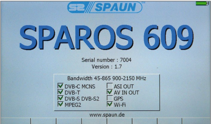
Après le redémarrage de l'analyseur, l'option Wi-Fi est indiquée comme activée
